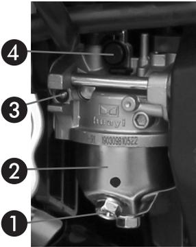
Öffnen Sie in Folge die Schwimmerkammer. Kontrollieren und reinigen Sie die Schwimmerkammer. Der Schwimmer muss sich leicht Auf- und Abbewegen lassen. Der Schwimmer ist hohl und darf nicht mit Benzin angefüllt sein. In diesem Fall hätte der Schwimmer ein Loch - dieses kann mit einem Benzinbeständigem Kleber geklebt werden.
