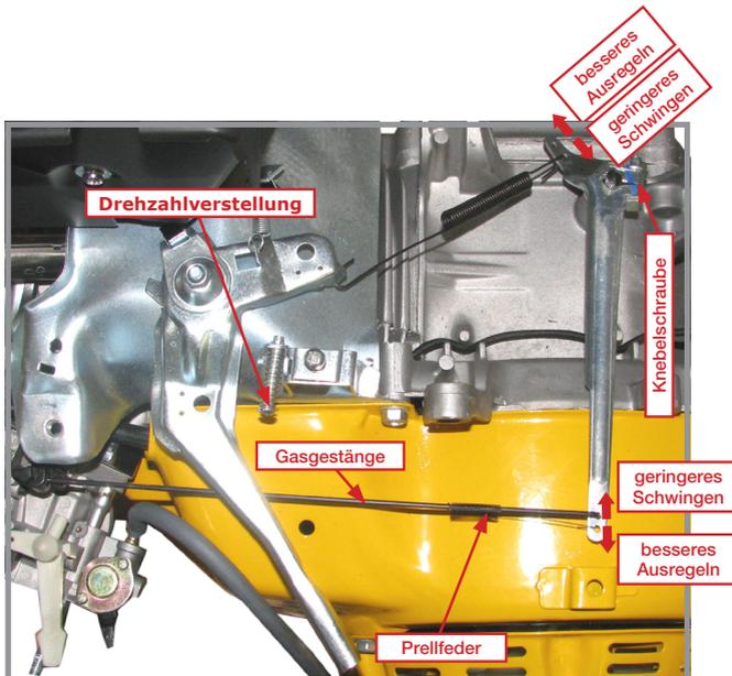
Der mechanische Drehzahlregler kann in seiner Regelcharakteristik verschiedentlich beeinflusst werden. Wesentlich ist die Ausregelung (wie sehr weicht die Drehzahl von der Idealdrehzahl ab) und das Schwingverhalten (Motor beginnt zwischen niedriger und hoher Drehzahl zu schwingen). Diese beiden Charakteristiken widersprechen einander.
