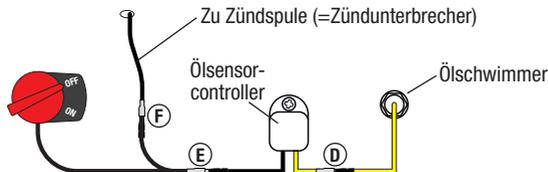
Öffnen Sie den Steckverbinder (E) - damit deaktivieren Sie die Ölkontrolle. Der Steckverbinder darf das Motorgehäuse im Betrieb nicht berühren. Kontrollieren Sie nun jedenfalls den Ölstand, da die automatische Ölkontrolle (Abschaltung) deaktiviert ist.
