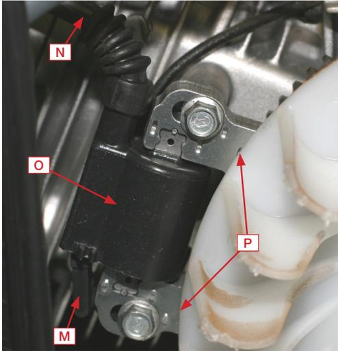
Ziehen Sie die Flachsteckhülse (M) ab - Kabel von Stecker (F) kommend.
